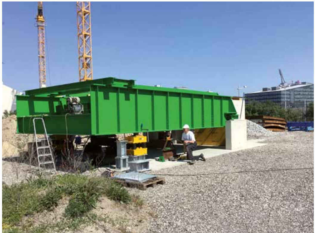
Versuchsanlage „schwingender Schot- tentrog mit Gleiskörper“ zur Erforschung des Dämpfungsverhaltens von Eisen- bahnbrücken bei Zugüberfahrten.
