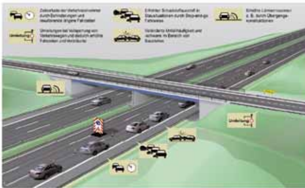
Externe Effekte bei Instandhaltungsmaßnahmen an Brücken
