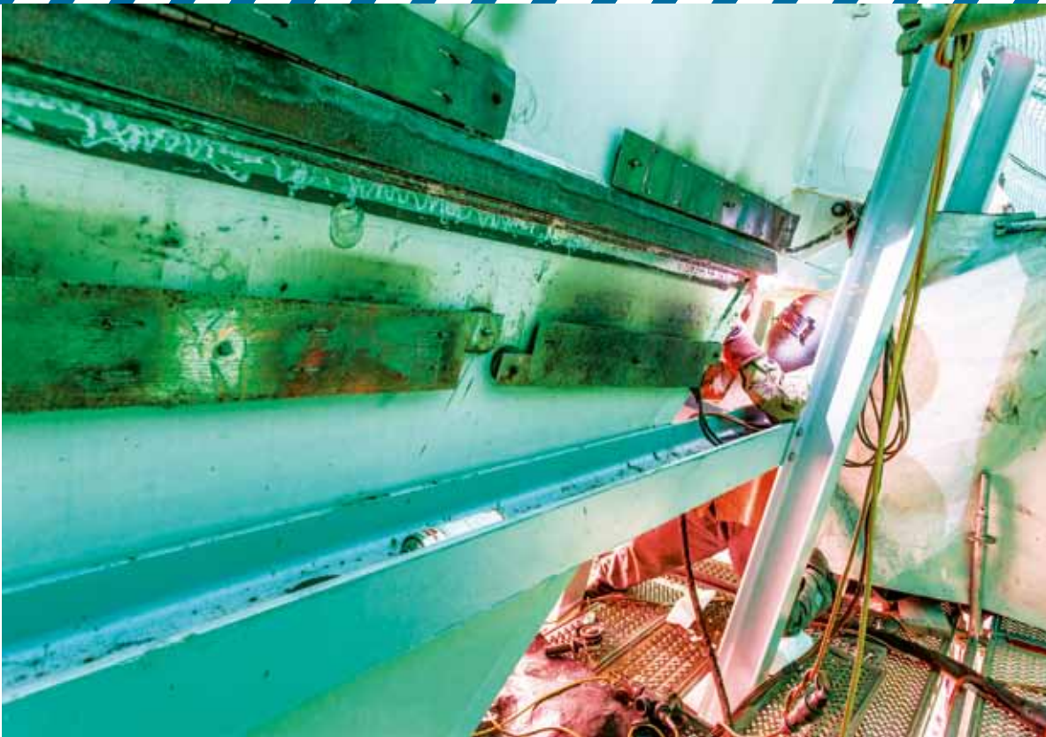
Die Bauteile werden vor dem Verschweißen konstant auf 100 °C gehalten.
