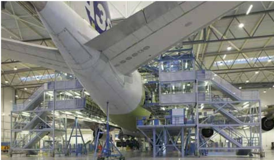
Spezialjob 1 für MCE: Vorrichtungen für den Bau von Flugzeugrümpfen
