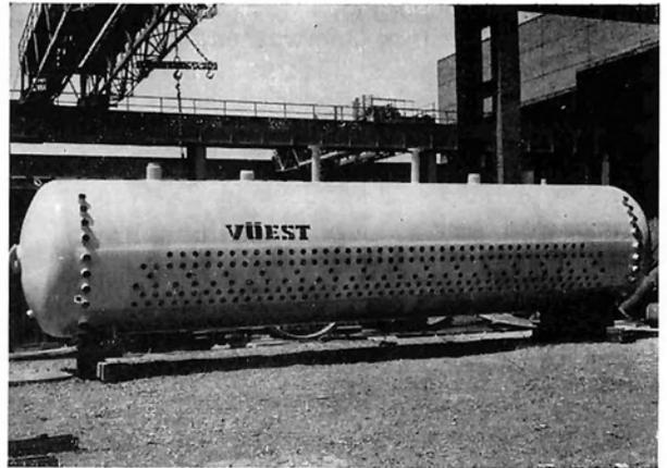
Bild 6: Kesseltrommel, 2,2 m Durchmesser, 50 kg/cm<sup>2</sup>
