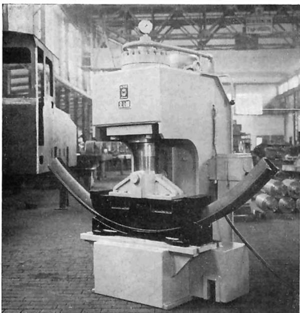
Bild 6: O.A.M.G., Werk Zeltweg: Einständer-Streckenbogen-Richtpresse
