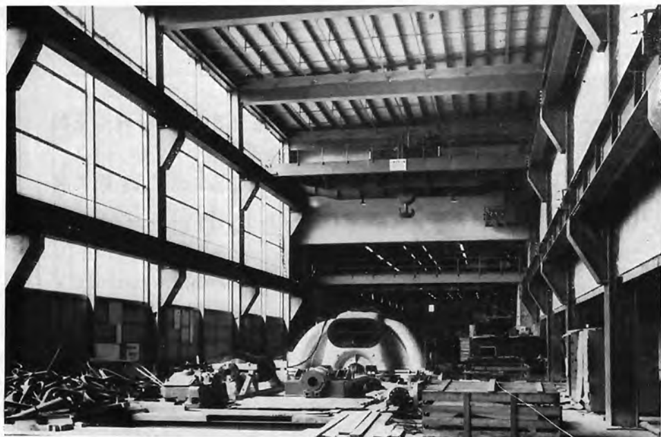
Generator-Trag- schirm, Schweißkon- struktion für Kraft- werk Ybbs-Persen- beug in Bearbeitung
