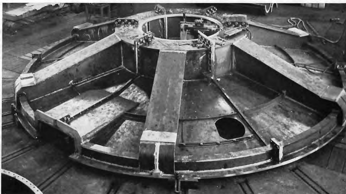
Generator-Trag- schirm, Schweißkon- struktion für Kraft- werk Ybbs-Persen- beug in Bearbeitung
