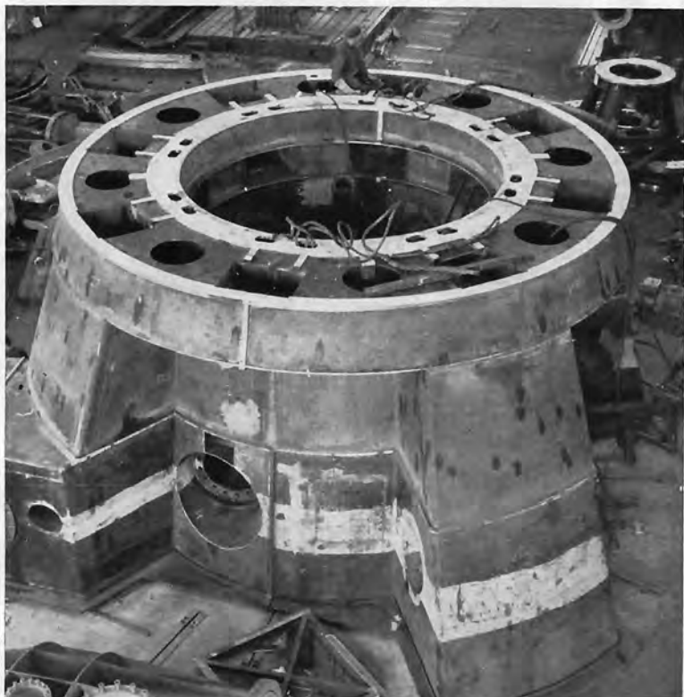
Geschweißtes Tur- binengehäuse einer vierdüsigten Frei- strahlturbine für das Kraftwerk Lünensee der Vorarlberger Illwerke A. G.
