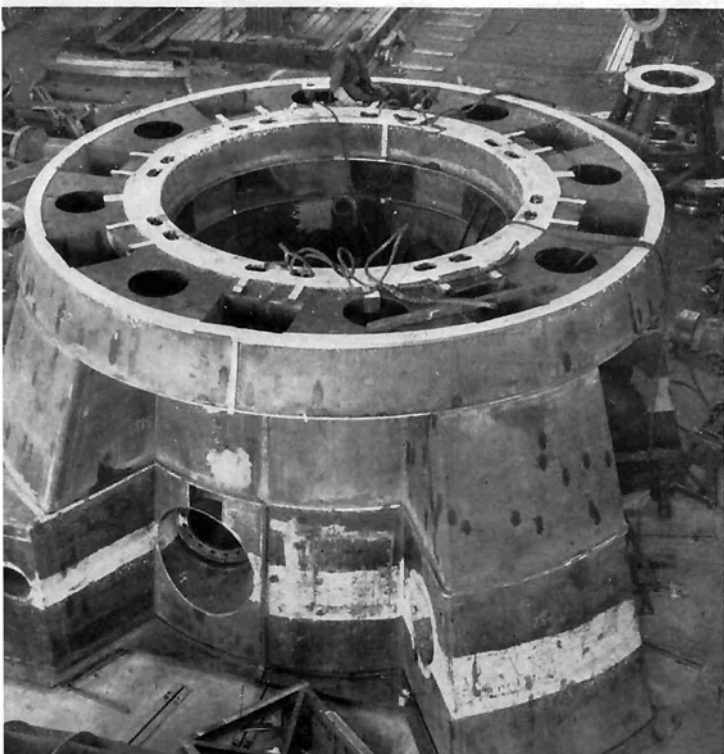
Geschweißtes Tur- binengehäuse einer vierdüysigen Frei- strahlturbine f. d. Kraftwerk Lünensee der Vorarlberger Illwerke A. G.
