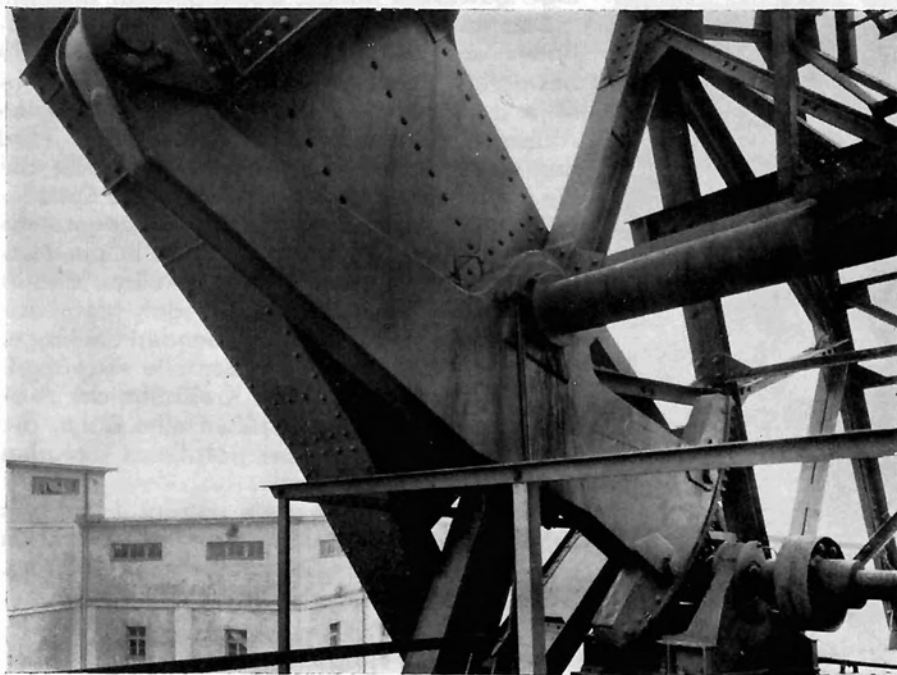
Bild 7: Antriebssegment für den Ausleger eines Wippdrehkranes Fig. 7: Drive gear segment for the jib of a luffing swing crane
