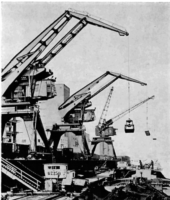
Wippdrehkrane im Hafen Linz mit horizontalem Lastweg für Massen- und Stückgutumschlag, Tragkraft 3,2 t bis 6 t bei Reichweiten von 21 bis 23 m
