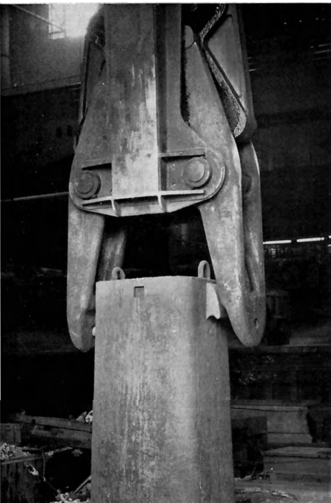
Oben Bild 5: Nach dem Strippvorgang wird die Kokille nach oben ausgefahren
