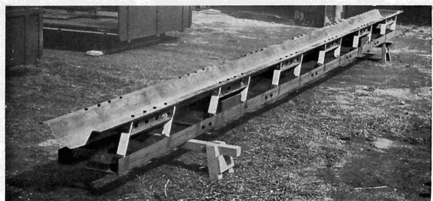
Bild 7: Elektromagnetisch angetriebene Schwingförderrinne
