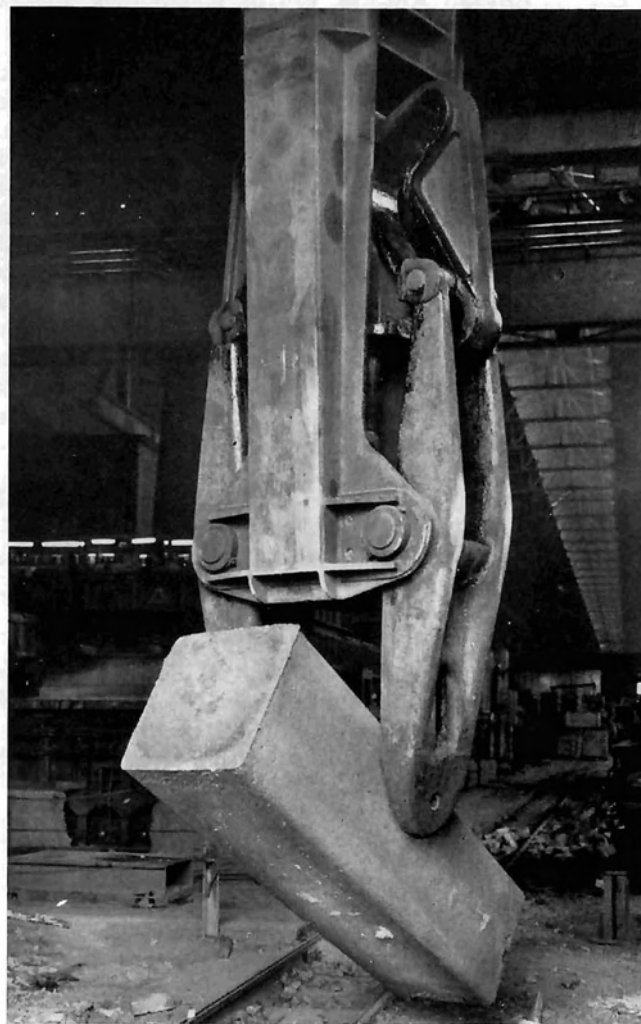
Bild 3: Kombinierte Tiefen- und Stripperzange mit einem von der Eingufswurzel abgedrehten Block Fig. 3: Combined soaking pit- and stripper tongue with inget twistet off the roof
