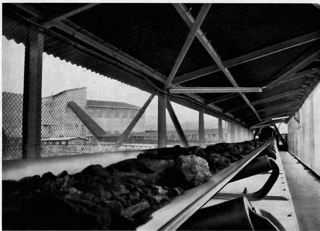
Bild 2: Bandbrücke vom Hochbunker Karl-Schacht zur Zentralsortierung
