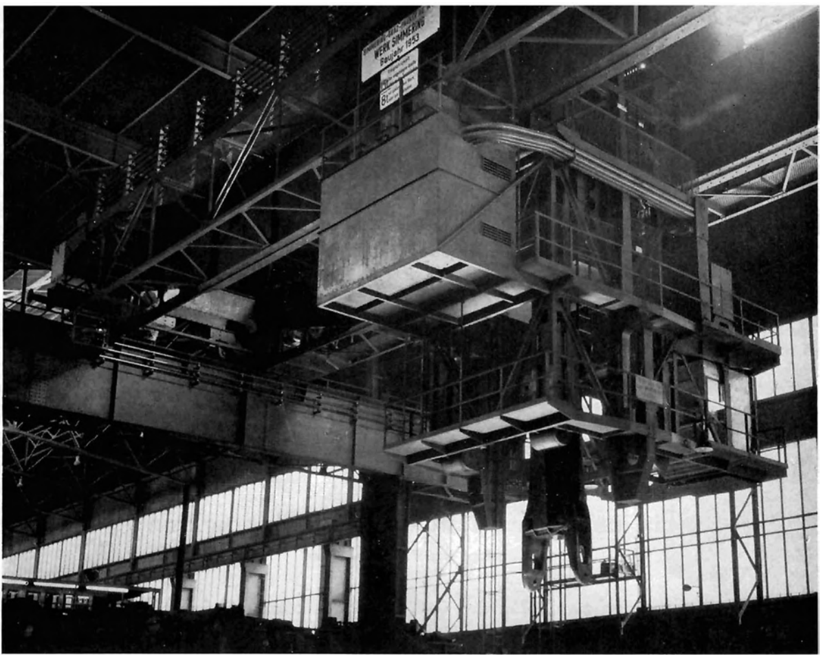
Bild 1: Stripperkran von 15 t Tragfähigkeit und 33 m Spannweite Fig. 1: Stripper crane, 15 tons capacity & 33 meters span
