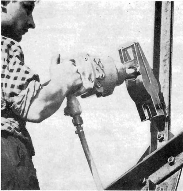
Bild 32: Eichvorrichtung für Schlagschrauber, Fabrikat: Wille, Tensimeter
