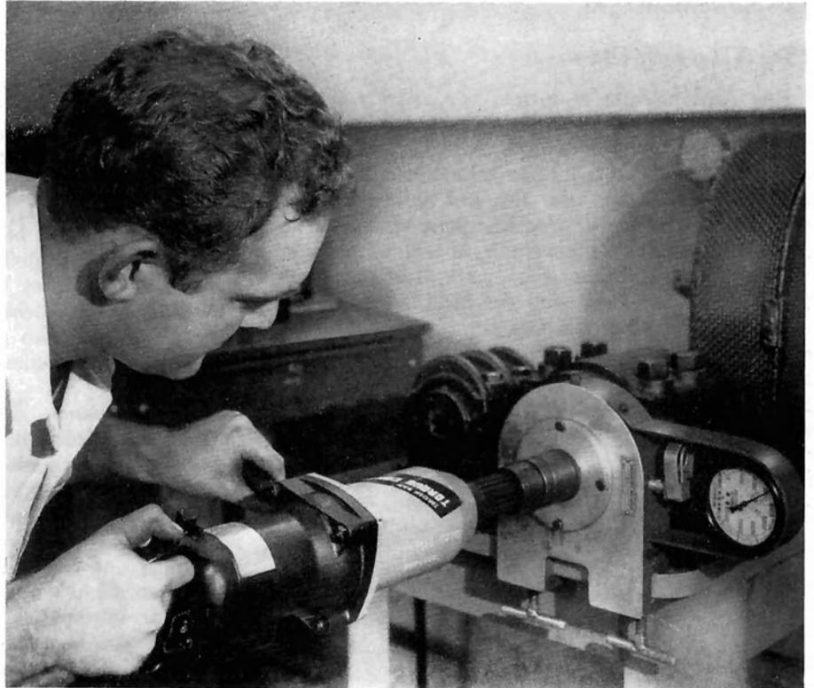
weiter zurücktreibt und damit über ein Ventil die Luftzufuhr sperrt. In einer entsprechenden Vorrichtung können durch Verdrehen der Muffe am vorderen Ende des Torsionsstabes die Vorspannung der Feder und damit das kritische Drehmoment verändert werden.
