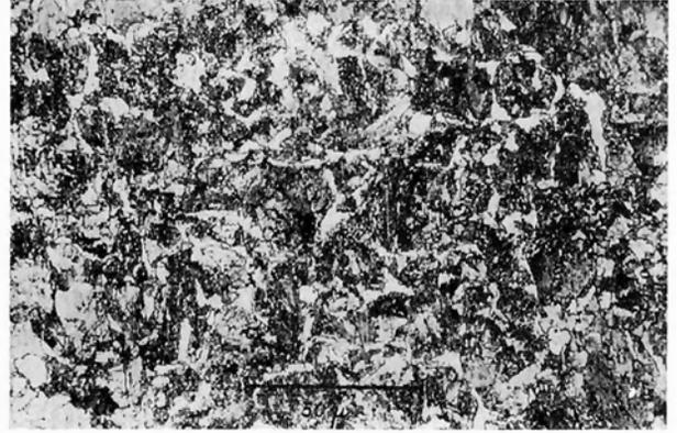
Bild 5: Werkstoff 41 Cr 4 SP, normalisierter Zustand, Ätzung 3% HNO<sub>3</sub>
