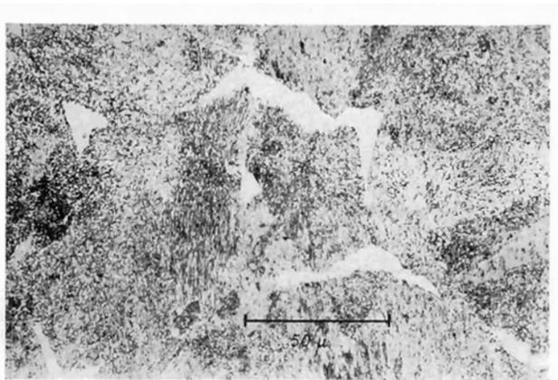
Bild 6: Werkstoff 41 Cr 4 SP, weichgeglühter Zustand, Ätzung 3% HNO<sub>3</sub>
