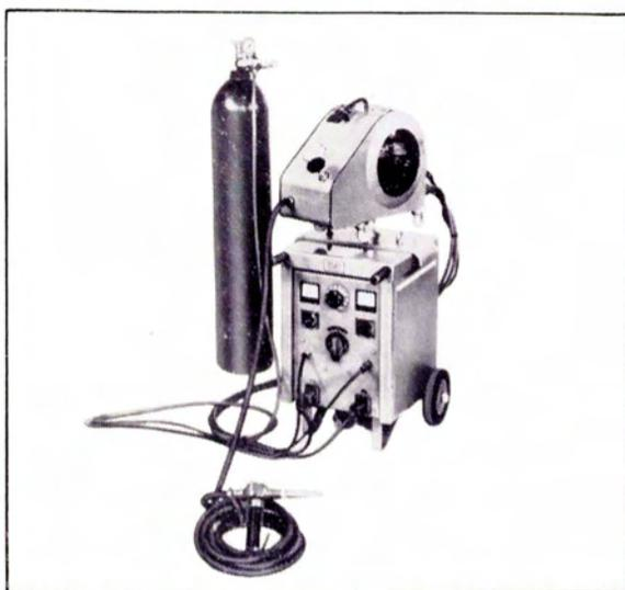
Schutzgasschweißen. Das A9-Gerät mit 200A oder 275 A Gleichrichter macht rationalisieren leichter. Schon erprobt und bewährt.
