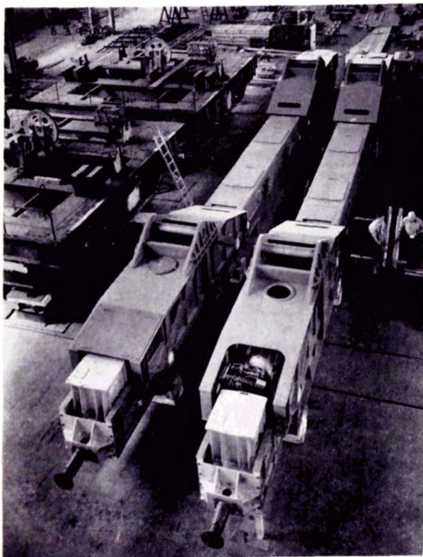
Bild 12: Zusammenbau der Fahrwerke für den 450-ton-Portalkran nach Bild 11 in der Werkstätte. Die komplett zusammengebauten Fahrwerke wurden sehr genauen Fluchtungsmessungen der Laufrollen und Fußbolzen unterzogen
