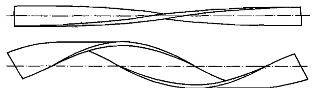
Bild 2: Dehnungslose Verformung durch reine Biegung anstelle von Torsion
