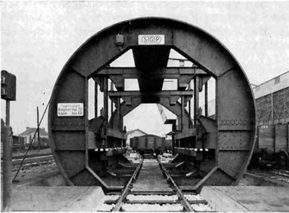
Bild 29: Kreiselwipper, 70/40 t Tragkraft
