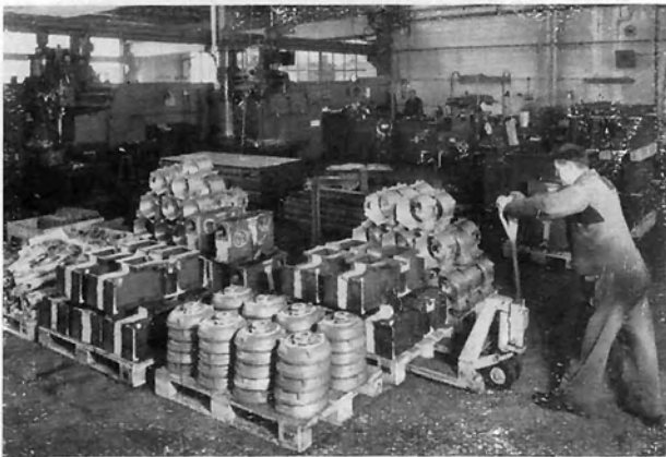
Bild 5: Auf Paletten geschichtete Maschinenteile und hydraulischer Handgabelhubwagen
