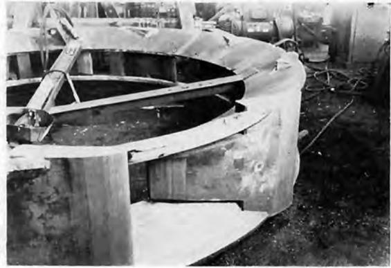
Bild 5: Turbinen-Traversenring „Jxtapantongo“ (Mexiko), vorbereitet zum Schweißen. J. M. Voith, St. Pölten
