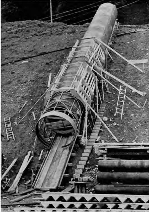
Bild 109: Röntgenfilmwagen zur Prüfung der Montage-rundnähte in der Stielstrecke des Druckschachtes des Lünserseewerkes. Rohrlänge 20 m, pneumatisches Anpressen der Filmkassette. Erprobung des Wagens an einem naturgroßen Holzmodell des Panzerrohres und der Schacht-Innenleibung. Dortmunder Union Brückenbau-AG, Werk Orange, Gelsenkirchen
