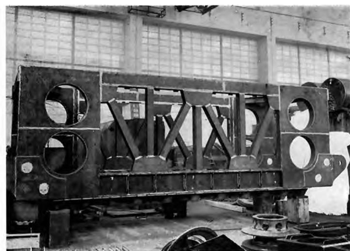
Bild 11: 100-MVA-Umspanner, Gitterträger
