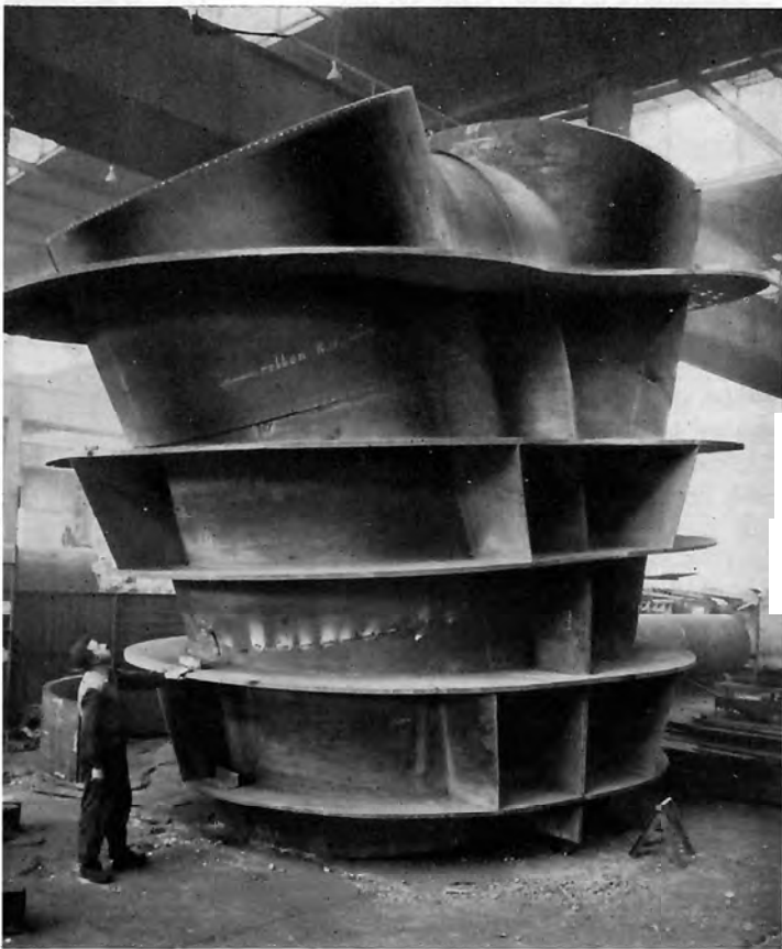
Geschweißtes Hosenrohr, zur Abnahme bereitgestellt. Welded "Wye" (forked tube) ready for inspection.
