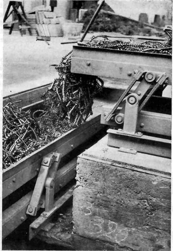
Transport von Drehspänen auf einer Schwingförderanlage in einer modernen Maschinenfabrik
