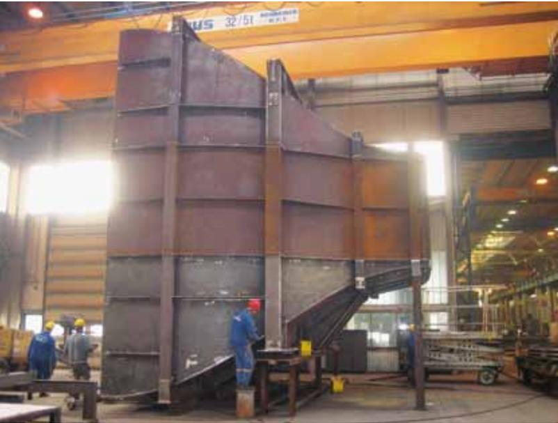
Probekonstruktion der Windkanaldüse im Fertigungswerk.
