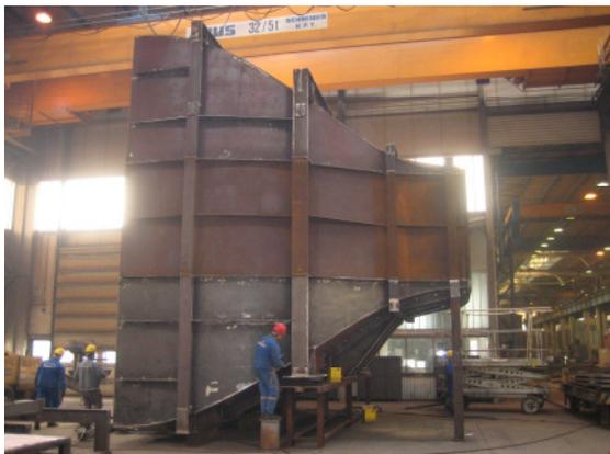
[4] Probezusammenbau der Windkanaldüse im MCE Fertigungswerk
