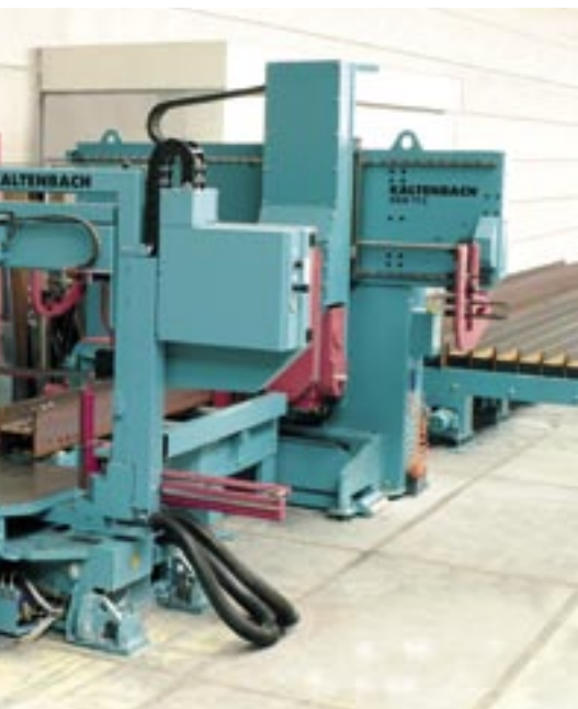
Kaltenbach KDM 712/1012 mit vollautomatischer Beschickung Stahlschnitte sowie Gutteile
