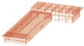
Bild 3: 3-D-Animation der Stahlkonstruktion
