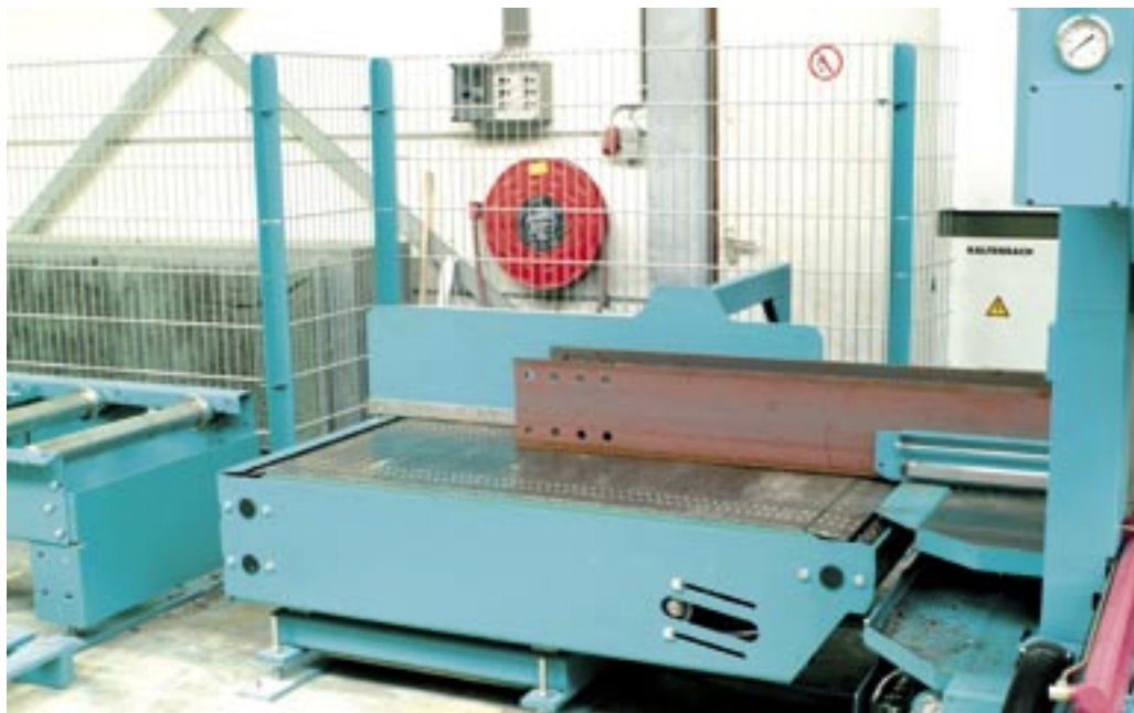
Die robuste Bauweise und ein 11 kW starker Bohrantrieb ermöglichen auch das Bohren mit Hartmetallwerkzeugen
