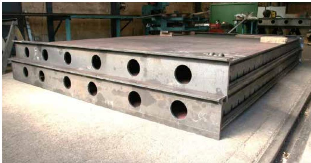
Die sogenannte Steel-Concrete-Steel-Composite (SCSC)-Sandwichplatte misst 200 mm, wobei jeweils oben und unten 15 mm dicke Bleche sitzen, zwischen welchen 170 mm Stahlbeton und sogenannte Schubleisten liegen, welche die beiden Bleche miteinander verbinden.
