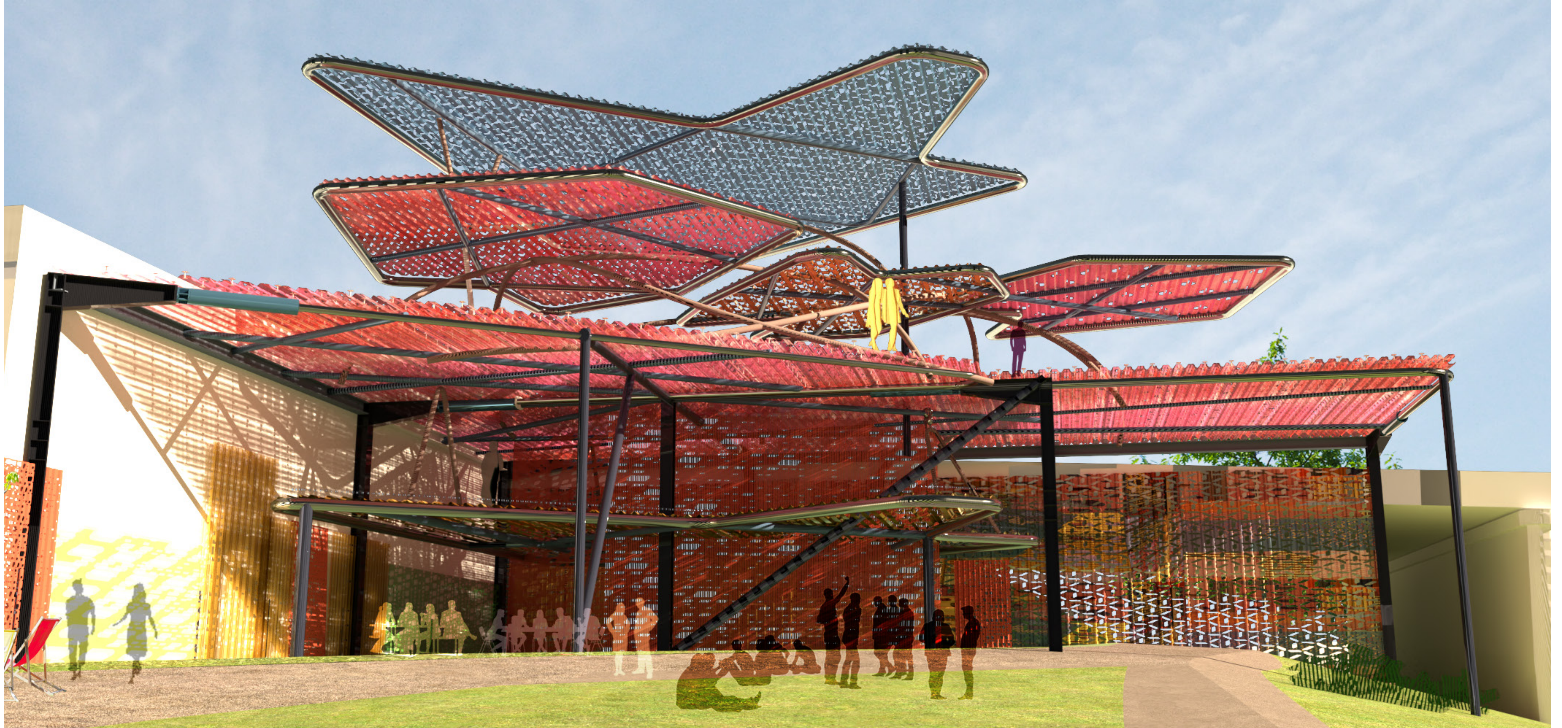
Haupttragwerkssystem aus Upcycling-Ware. Profilschnitten/Standardverbindungen
