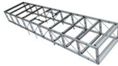
Die außenliegende Stahlkonstruktion des Riegels mit thermisch entkoppelten Durchdringungen
