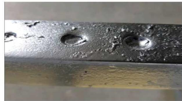
**Achtung:** Auf Grund der Temperaturunterschiede beim Eintauchen vom Material/Bauteil (*20 bis 50°C im Schnitt*) und dem Zinkbad (*450°C und höher (HT-FVZ)*) kommt es bis zum Temperatenausgleich bei kleineren Öffnungen zum sogenannten Einfriereffekt („*Erstarren von Zink*“, *Schmelzpunkt von reinem Zink: 419,5°C*). Deshalb sollten die Lochdimensionen immer so groß wie möglich gewählt werden.
