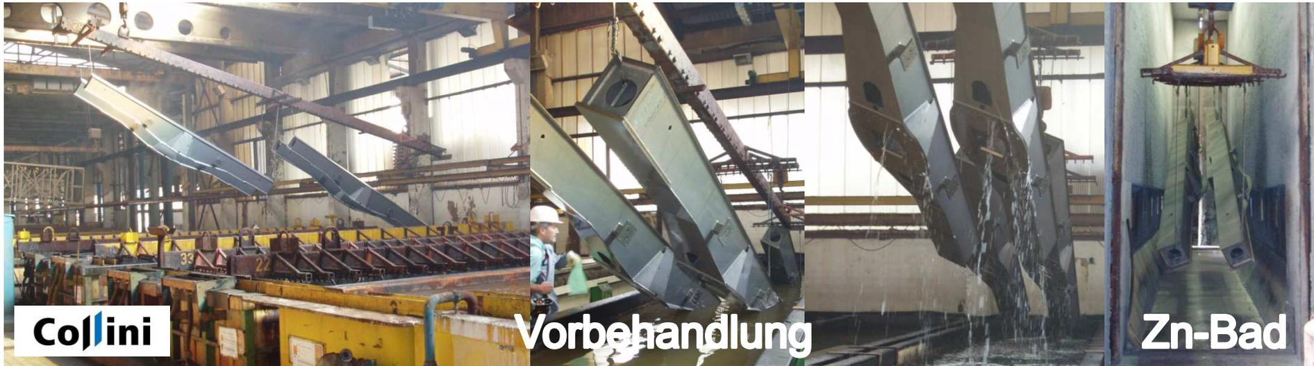
**Zink (Flüssigkeit) muss möglichst rasch fließen und Luft entweichen können (Auftrieb, Explosionsgefahr, Verzug,...) !!!**
