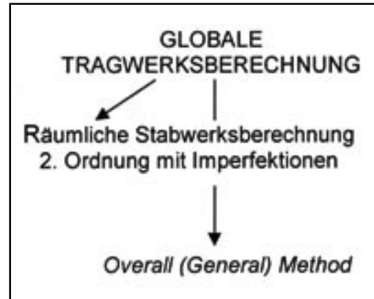
Bild 2: Überblick über die Methoden der Tragwerksberechnung
