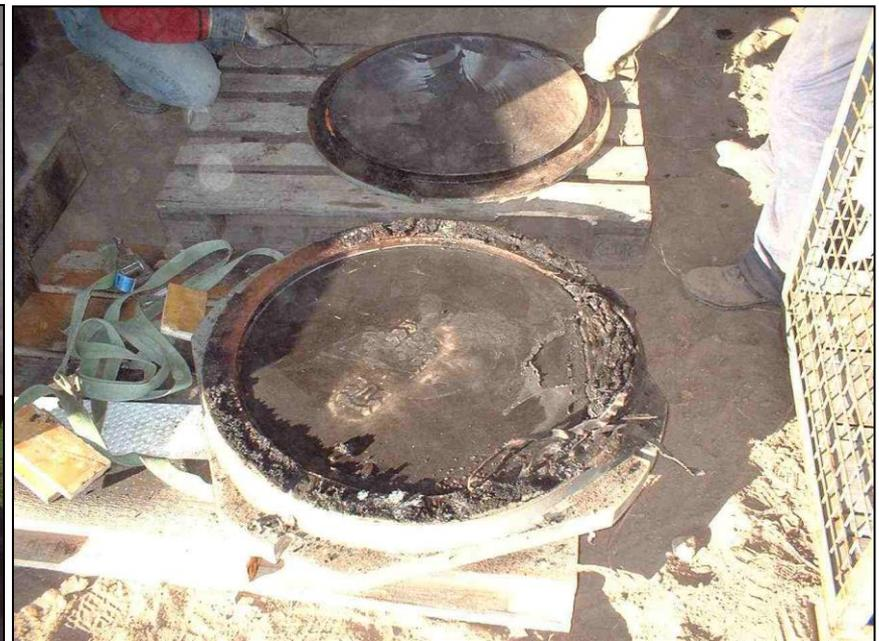
🏠 Fehlfunktion des Elastomerkissens u. a. durch Versagen der Dichtung
