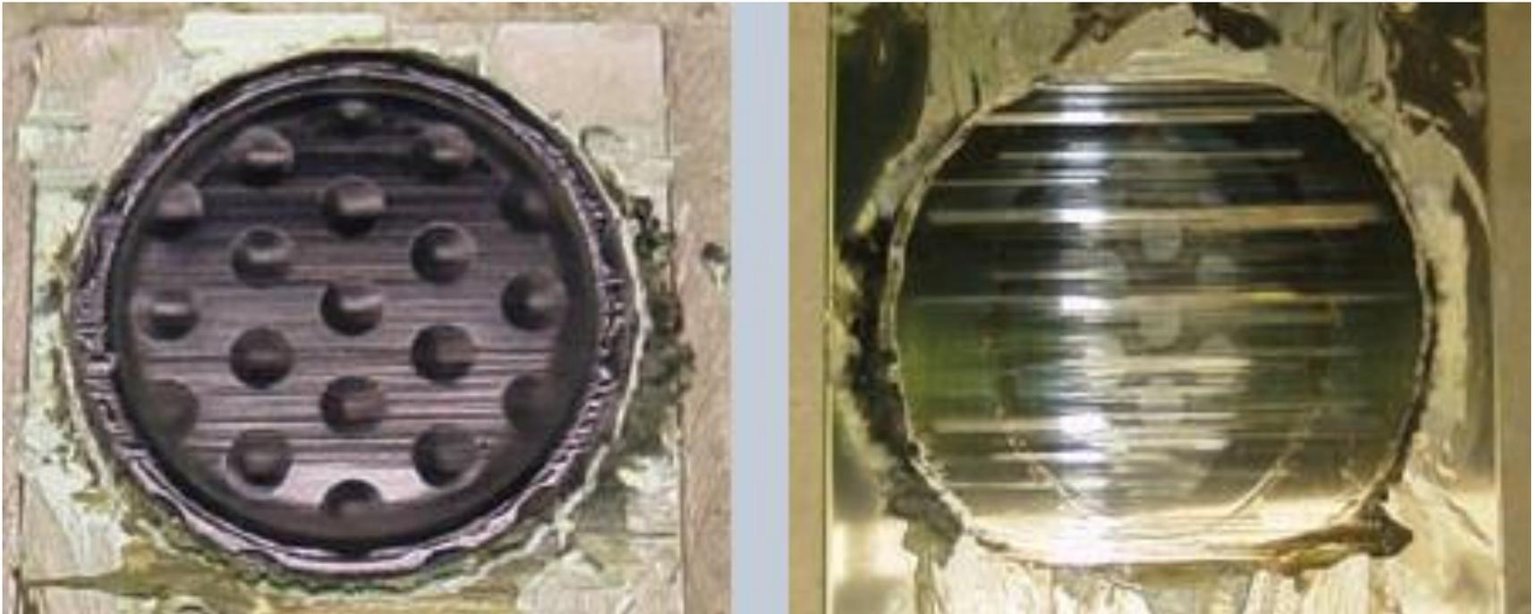
🏠 MSM<sup>®</sup>: Versuchsergebnis bei 60N/ mm<sup>2</sup> dynamischer Flächenpressung und 15mm/ s Gleitgeschwindigkeit nach Abschluss des aufsummierten Gleitweges von 50km (MPA Stuttgart) >> keine erkennbaren Verschleißerscheinungen, lediglich Riefenbildung
