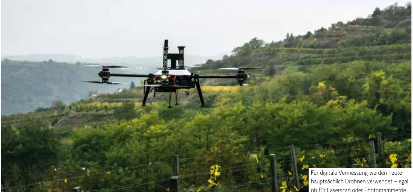
Für digitale Vermessung werden heute hauptsächlich Drohnen verwendet – egal ob für Laserscan oder Photogrammetrie.
