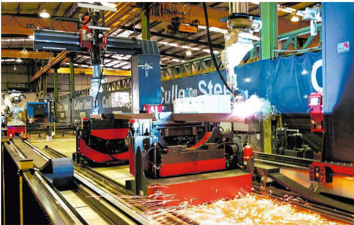
Am Steel Beam Assembler können Stahlträger mit einer Länge von 18m und einem Gewicht von 6000 kg vollautomatisch bearbeitet werden
