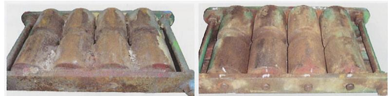
Bild 4. Walzenpaket eines 4-Rollen-Wälzlagers mit Käfig, links im ungereinigten Zustand, rechts im gereinigten Zustand
