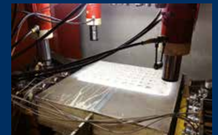
Versuchskörper einer SCSC-Sandwich-Platte in der Versuchsanlage
