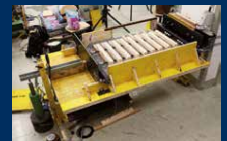
Zur Erforschung der dynamischen Eigenschaften des Schotterbettes bei Zugüberfahrt einer Brücke: die "schwingende Schotterkiste" (Maßstab 1:5)
