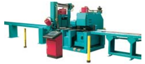
Erstmals auf der IPS in Lörrach vorgestellt: Die Stanz-Scher-Anlage KPS 506 – ausgelegt für die automatische Verarbeitung von Flach- und Winkelstahl
