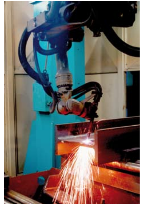
Ferroflex freut sich über lohnende Investition in Technologie von Kaltenbach – im Bild der Ausklinkroboter
