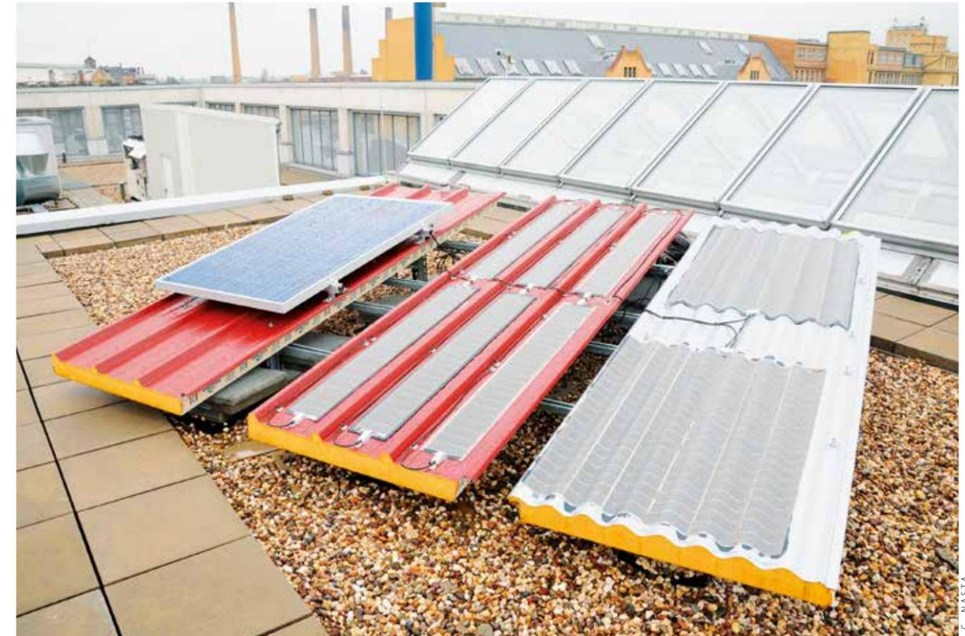
Outdoormessstand für Sandwichelemente mit integrierter Fotovoltaik der HTW-Berlin
