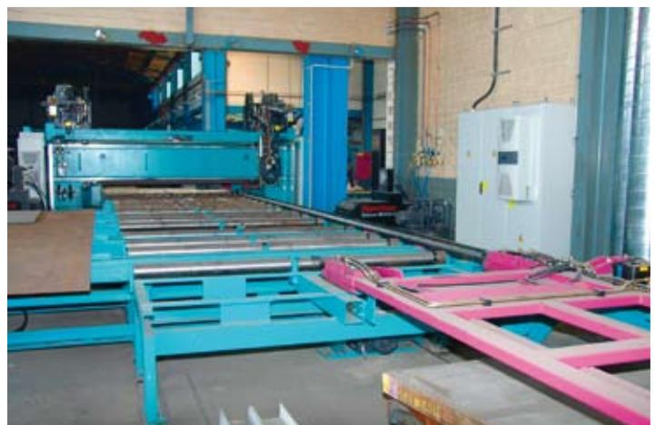
Mit dem Einsatz der Plattenbrennbohrmaschine KF 2512 von KALTENBACH verdoppelt die Dürener Stahlbaufirma Bruno Caspers den Materialdurchsatz.
