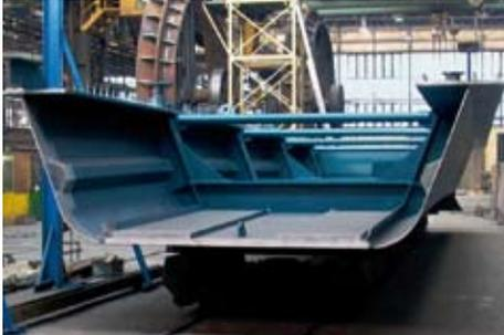
Bild 5: Querschnitt (Fertigung bei MCE Slany)
