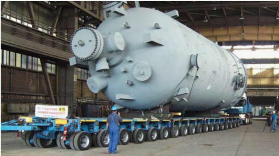
Der 500 Tonnen schwere Methanolreaktor wurde vom MCE Maschinen- und Apparatebau an den Konzern Petronas geliefert.
